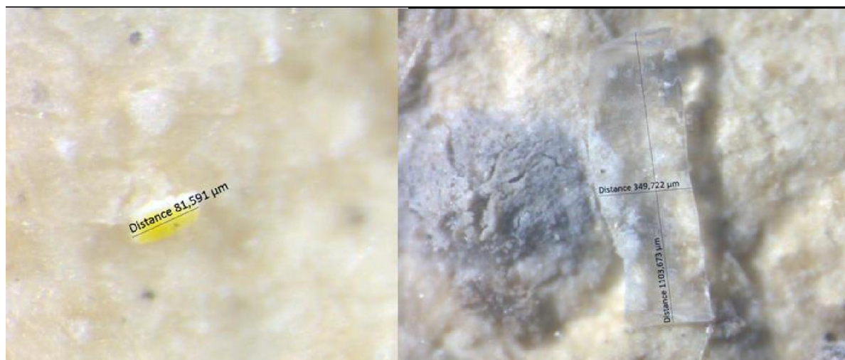
Εικ. 49. Φωτογραφίες ανιχνεύσιμων μικροπλαστικών μετρούμενες μέσω λογισμικού ανάλυσης εικόνας.
