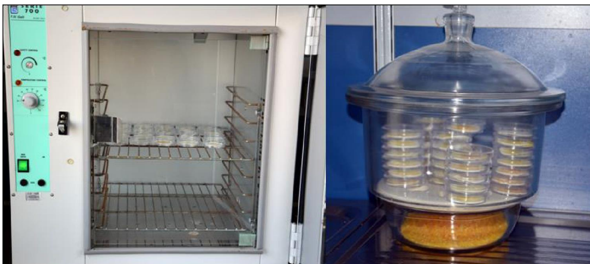
Εικ. 47. Διαδικασία ξήρανσης: τρυβλία Petri με φίλτρο σε επωαστήρα (αριστερά) και σε γυάλινο ξηραντήρα (δεξιά).
